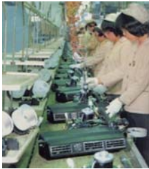
カーエアコン組付ライン 大勢の人の手で組み付けられていたんですね
