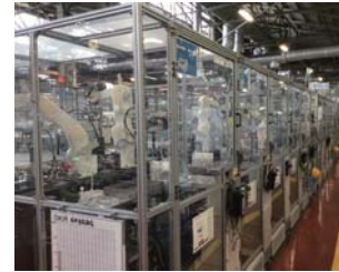
カーエアコン(HVAC)組付ライン ロボットによる自動組付けが行われています
